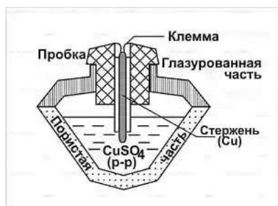
Рис. 1 Неполаризующийся электрод конструкции ВИРГ.
