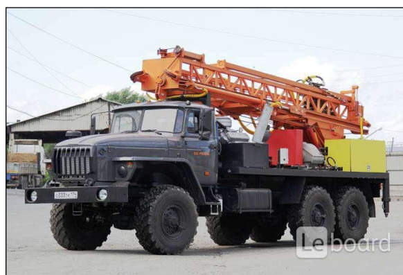
Сурет 3.2.1.1-УРБ ЗАЗ бұрғылау қондырғысы
