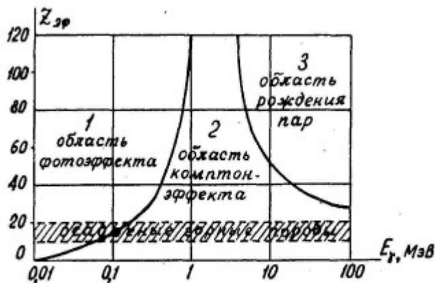
Рис. 12.6. Вероятность различных видов взаимодействия \gamma -излучения с веществом в зависимости от его энергии и эффективного атомного номера вещества
