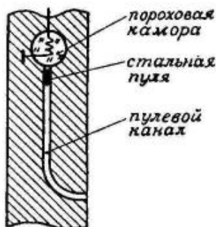
Сурет. 20.3. Тік оқты перфоратордың құрылысы
