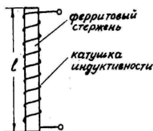
Сурет 18.1 КМВ аспабындағы құрылғының конструкциясы
