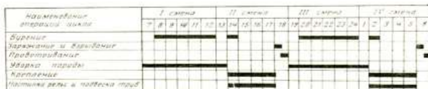
Рис. График цикличной организации работ при параллельном выполнении проходческих процессов
