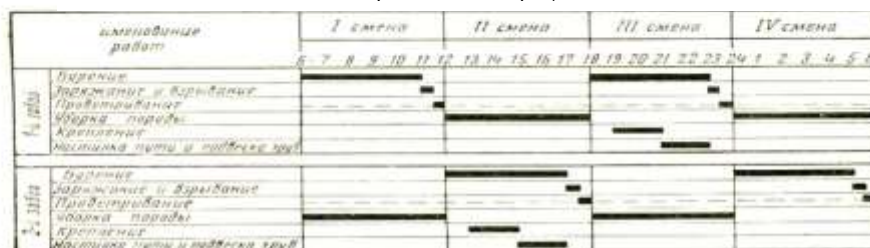
Рис. График цикличной организации работ при комбинированном выполнении проходческих процессов
