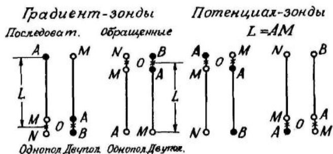
Рис. 5.3. Градиент- и потенциал-зонды КС
