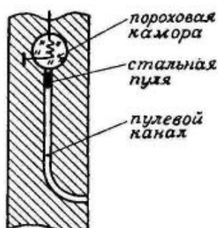
Рис. 20.4. Устройство вертикального пулевого перфоратора
