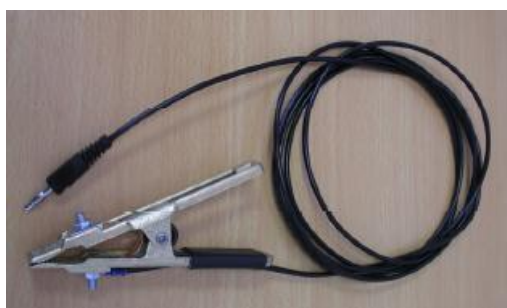
Фото 3: Тонкий испытательный проволочный вывод для подсоединения электрода к пульту SSPR
