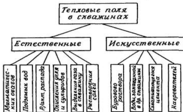
Рис. 15.1. Классификация тепловых полей в скважинах по их происхождению
