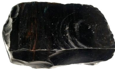
Рис. 106. Стекловатая структура в обсидиане (вулканическое стекло).
