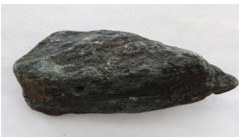
Рис. 133. Хлоритовый сланец. Структура-скрыто-чешуйчатая, мелкозернистая; текстура-сланцеватая. Наличие магнитных свойств
