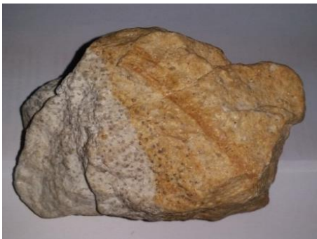
Рис. 93. Мелкозернистая структура в гранит - аплите, жильная порода (контактная зона) светлый-полевой шпат (кислый плагиоклаз), сероватый-кварц.
