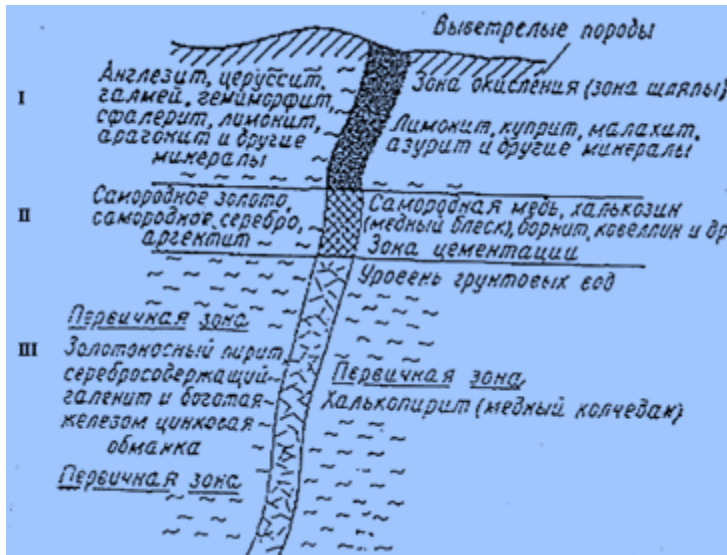
Рис.47. Схема окисления сульфидного месторождения: I-зона окисления; II-зона вторичного сульфидного обогащения (зона цементации); III-зона первичных руд
