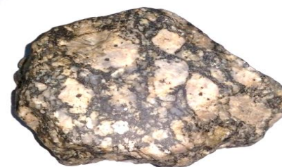
Рис. 97. Порфирированная структура в порфирированном граните. Порфирированные включения представлены калишпатом - светло-серый.
