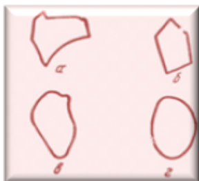
Рис. 111. Форма обломочных зерен: а – оскольчатая, б – угловатая, в – полуокатанная, г – окатанная.
