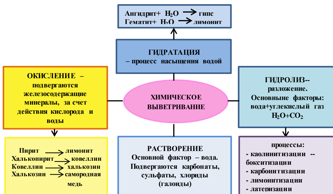
Рис.46.Схема химического выветривания
