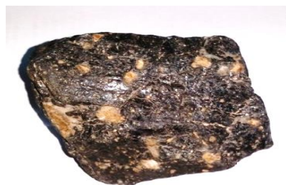
Рис.107. Витрофирная структура в витрофире, черный-вулканическое стекло, желтоватые вкрапления-калишпат (витрофир)
