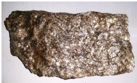
Рис. 132. Серицит-гранатовый сланец: минеральный состав: - серицит, гранат, кварц, кальцит; структура: лептдобластовая, гранобластовая; текстура: сланцеватая, массивная; перламутровый блеск
