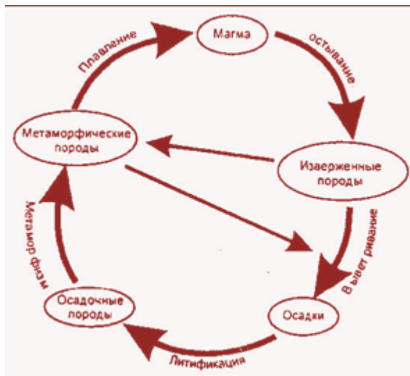
Рис. 90 Геологический цикл формирования горных пород.
