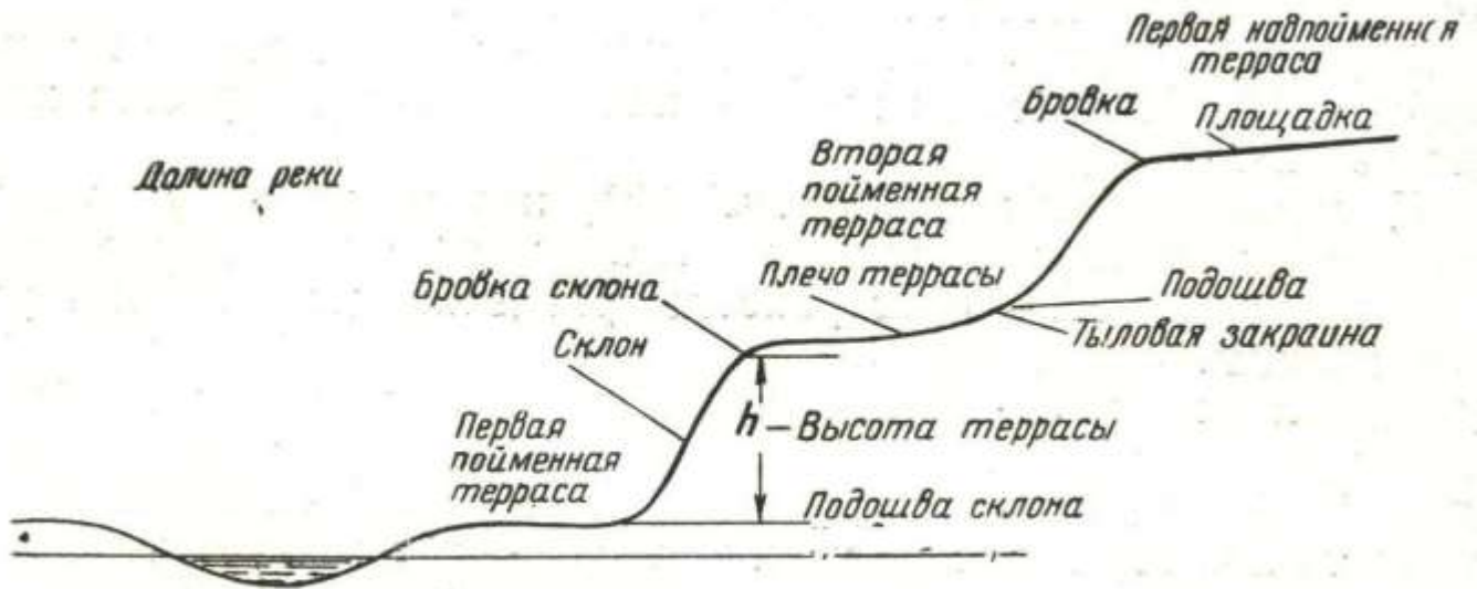
Рис. 83. Схематический разрез террасы с указанием ее элементов
