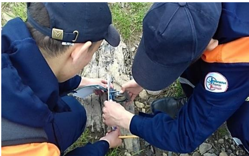
30 сурет. Далалық жағдайларды қабаттың құлау бұрышын өлшеу
