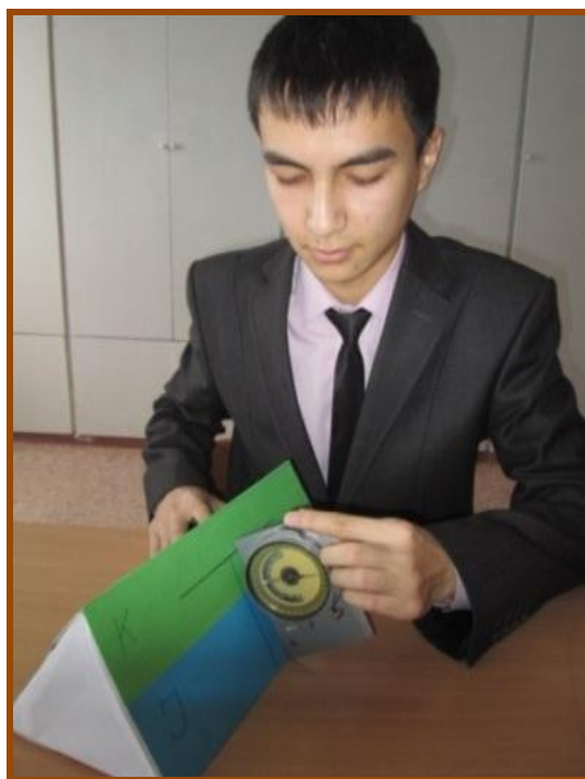
29 сурет. Қабаттың құлау бұрышын өлшеу
