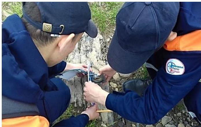
Сурет-43. Далалық жағдайларды қабаттың құлау бұрышын өлшеу
