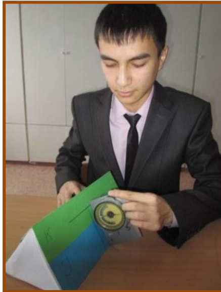
Сурет-42. Қабаттың құлау бұрышын өлшеу
