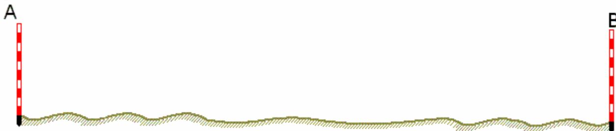
Рис. 49. Измерение линии мерной лентой
