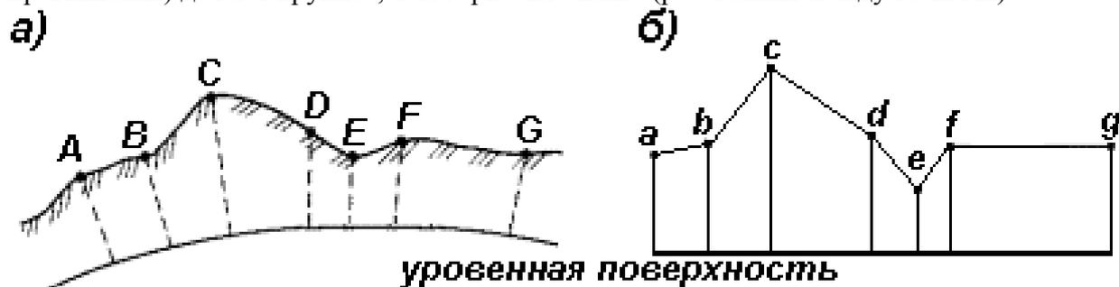
Рис. 27. Вертикальный разрез (а) и профиль (б) местности
